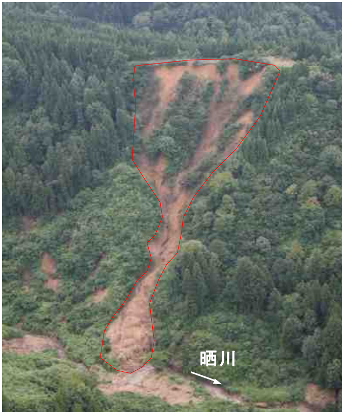
【崩壊箇所全景】 尾根部から晒川に達する大規模な崩壊 晒川の河岸で多くの崩壊が発生した
